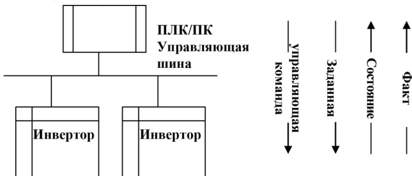
Схема подключения управляющей шины
