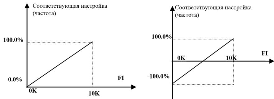
Рис. 6-15 Отношение между входным импульсом и настройкой
