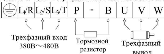
Примечание: клеммы питания L1/R, L2/S однофазного тока 230В мощностью 1,5кВт и 2,2кВт подключаются к сети питания 230В; клемма L3/T не подключается. № клемм —|| для инверторов мощность не более 11кВт.
