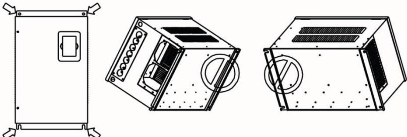
**Рис. 1-2 Вертикальный монтаж**
