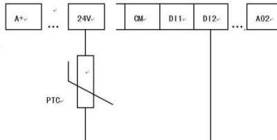
Рис. 6-6 Защита от перегрева РТС
