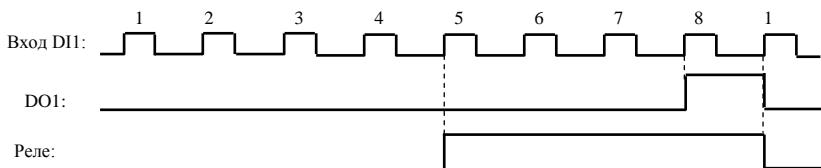
Рис. 6-10 Заданные тактовые частоты и фактические тактовые частоты
