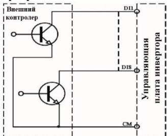
Если клеммы цифрового ввода управления подключаются к электроду стока, переведите переключатель в положение PNP. Электропроводка клемм управления:
