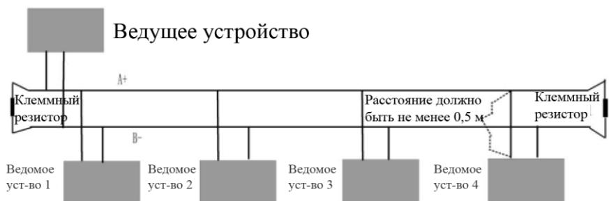
**Схема подключения клеммного резистора**
