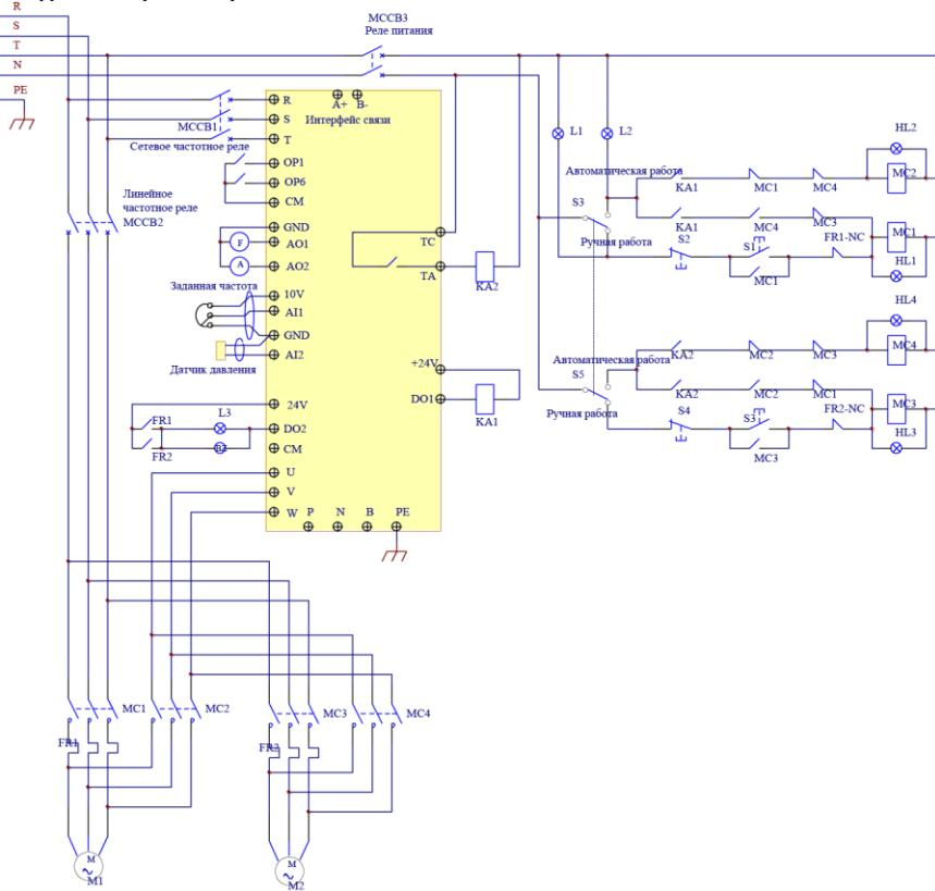
1. Подключите проводку согласно схеме выше, проверьте проводку, закройте MCCB3
