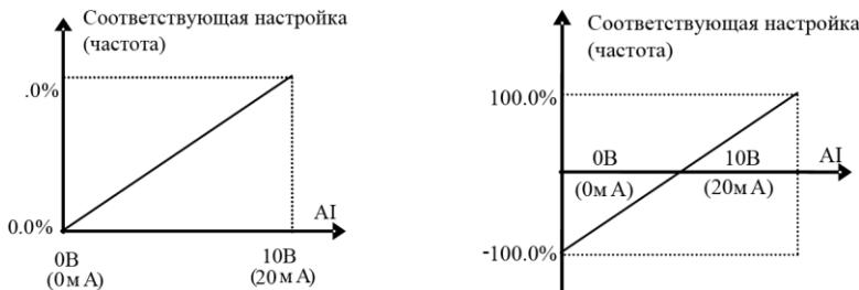
Рис. 6-13 Соответствие аналогового входного сигнала настройке
