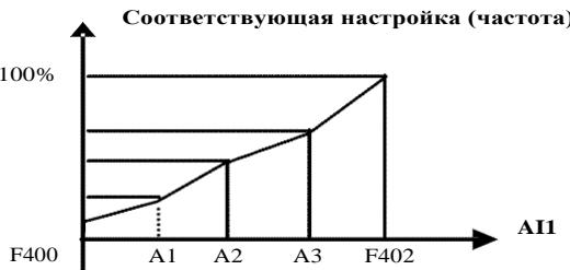
**Рис. 6-17 Значение параметра криволинейного аналогового сигнала**
