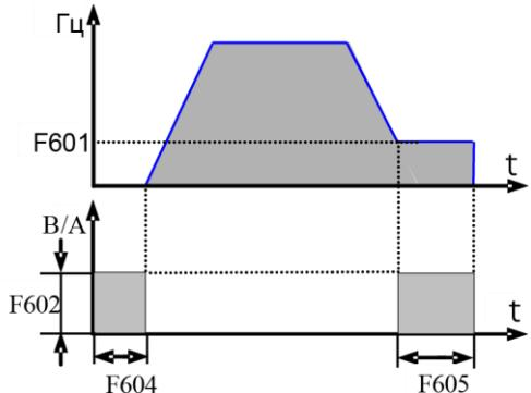
**Рис. 5-18 Торможение постоянного тока**
