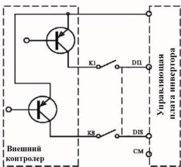
Электропроводка с учетом электрода источника в наименее используемом в настоящий момент режиме Электропроводка для клемм управления подключается к электроду-источнику, пользователь должен выбрать режим электропроводки в зависимости от требований.
