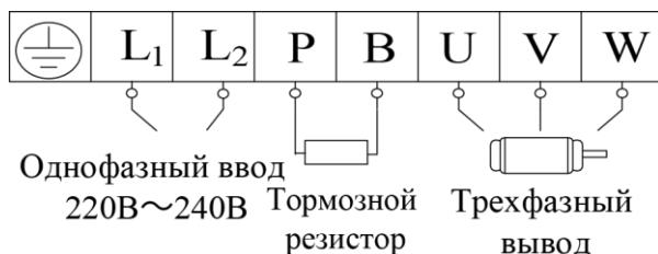
Клеммы питания инвертора с однофазным током напряжением 230В и мощностью 1,5- 2,2кВт и с трехфазным током 400В и мощностью 0,75кВт~22кВт.
