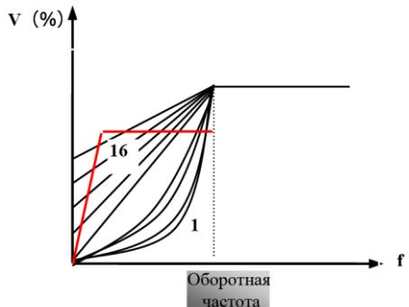
**Рис. 6-3 Распространение вращающего момента**
