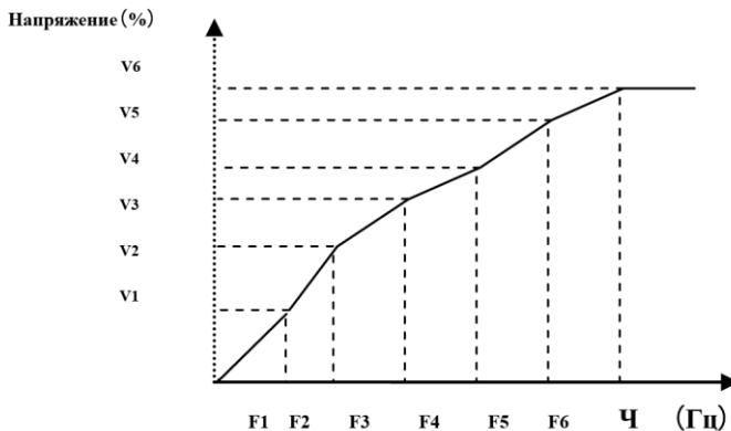
Рис. 6-4 Кривая Н/Ч в виде ломаной линии
