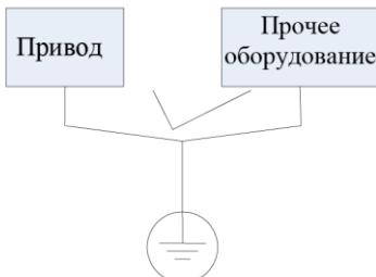
Общий кабель заземления (неприемлемо)
