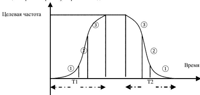
Рис. 6-9 На S-образной кривой ускорения/замедления
