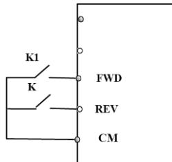
2. Двухлинейный режим 2: когда этот режим используется, клемма FWD (Вперед) является пусковой, а направление контролируется клеммой REV (Назад).
