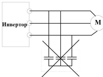
**Рис. 1-4 Запрещается использовать конденсаторы.**
