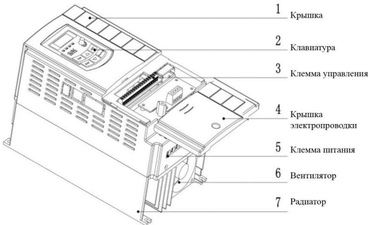
При изготовлении металлических кожухов используется высокая технология напыления пластика и порошка на поверхность, обеспечивающая приятный цвет. Кожух имеет одну съемную шарнирную дверцу, адаптированную под переднюю крышку, что облегчает электропроводку и техобслуживание. На примере Е2000-0307T3 рассмотрим внешний вид и конструкцию инвертора, как показано на Рис
