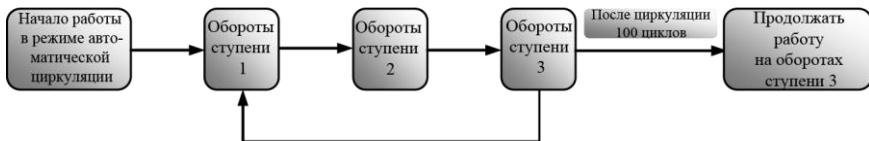
Рис. 6-18 Работа в режиме автоматической циркуляции
